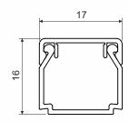
Produktbeschreibung: bestimmt zur Installation von Niederspannungsleitungen
