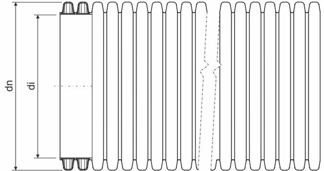
**Produktbeschreibung:** halogenfreies, doppelt beschichtetes starres Rohr zum mechanischen Schutz aller Arten von Strom- und Datenkabeln, für den universellen Einsatz im Erdreich
