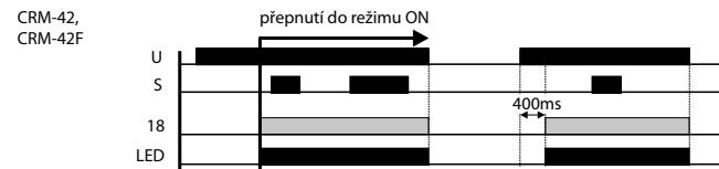
**Režim AUTO** - ve funkci AUTO při stisku ovládacího tlačítka dojde k sepnutí výstupu a po odčasování nastaveného času dojde k rozepnutí výstupu.
